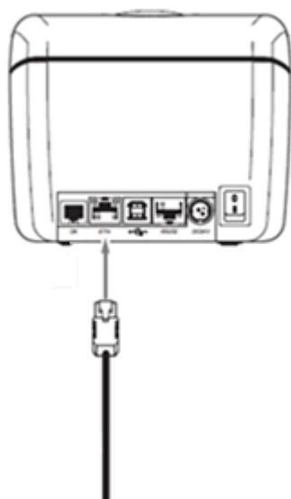
Рисунок 1. Подключение Ethernet кабеля к ККТ Q3X-Ф.
